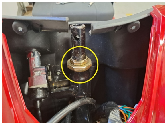
Irrota ohjauslaakerin lukitusmutteri (kiintoavain 32 mm) ja ohjauslaakerin kirstysmutteri. (kiintoavain 45 mm).
