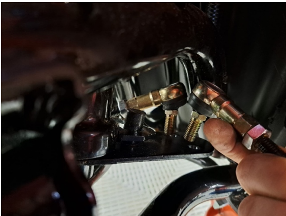
Nosta raidetangon päät irti ohjausakselista.
