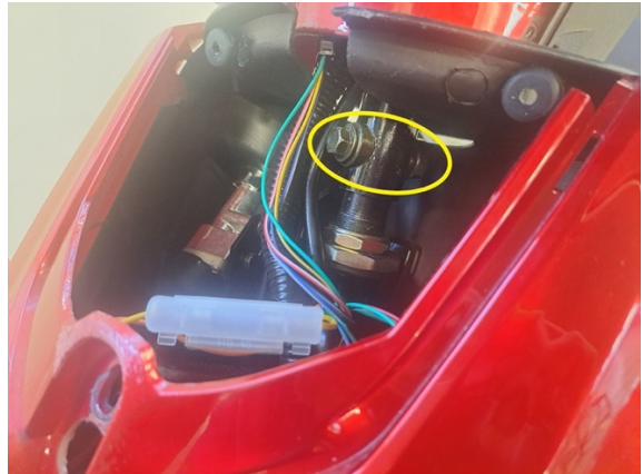
Irrota ohjaustangon kiinnityspultti (kiintoavain 12 mm) jolla on vastamutteri. (kiintoavain 14 mm).
