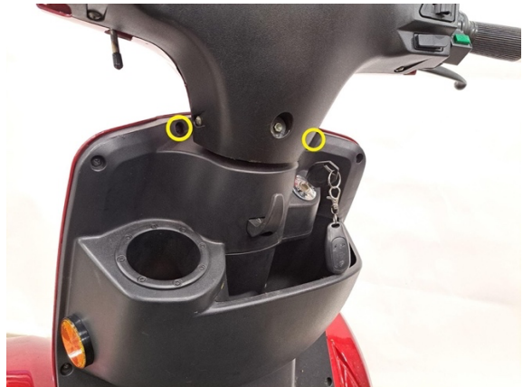
Avaa keulapaneelin kiinnitysruuvit. (ristipäämeisseli ph2).
