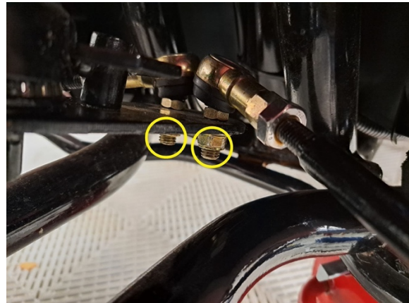
Irrota raidetangon sisäpäiden kiinnitysmutterit (kiintoavain 14 mm) ohjausakselistä. Jos kiinnitysmutterit pyörii tyhjä, niin raidetangon pään suojakumin puolelta voi pitää vastaan. (kiintoavain 12 mm).
