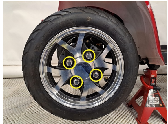
Irrota etupyörän kiinnityspultit. (hylsy 19 mm).
